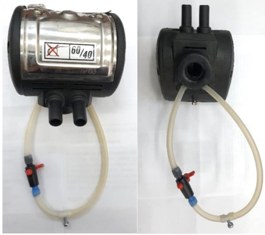
Şekil 4.1. Pnömatik pulsatör üzerindeki hızlı masaj tasarımının görünüşü
