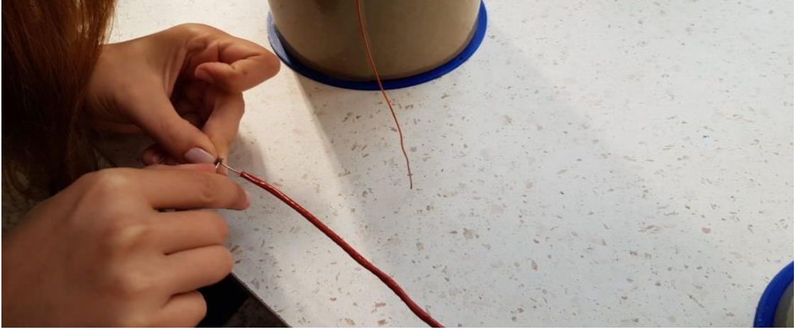
Şekil 3.13. Elektrik devresi bağlantı noktaları hazırlanması
