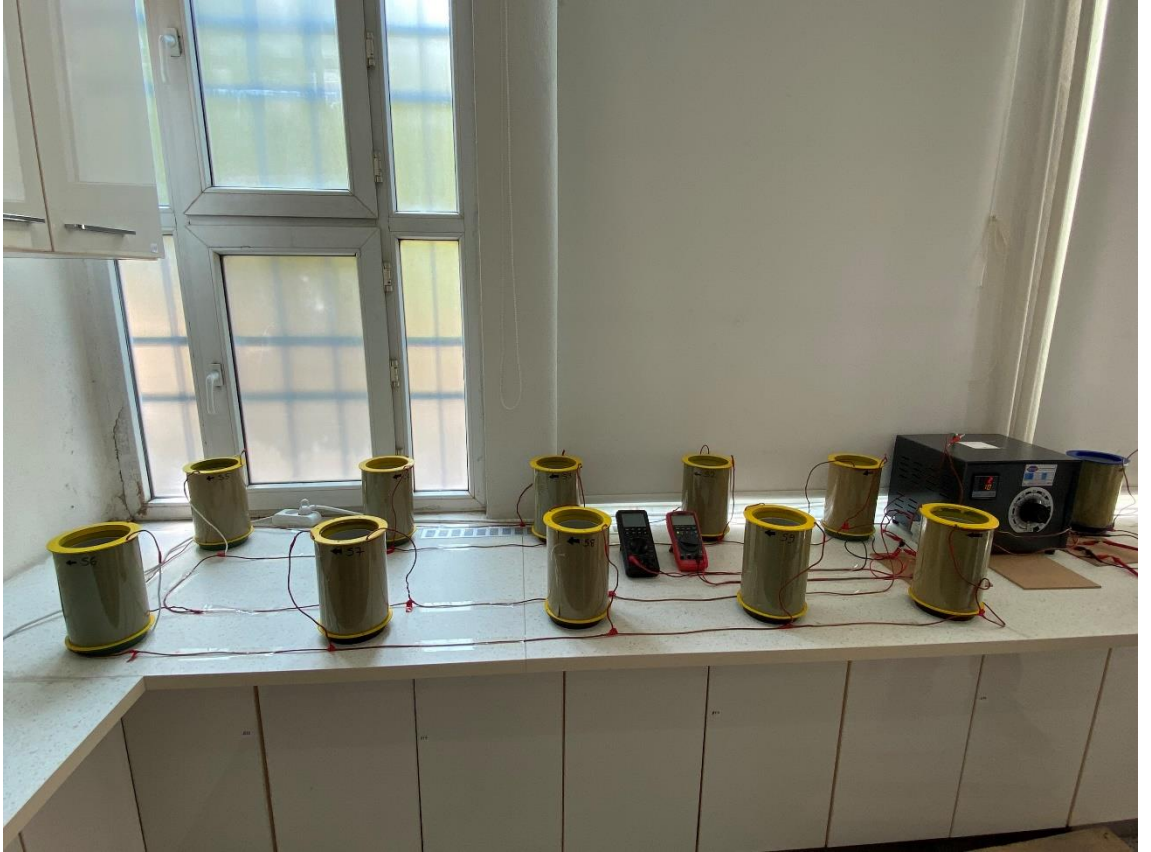
Şekil 3.14. Hazırlanmış bobin saksı devresi
