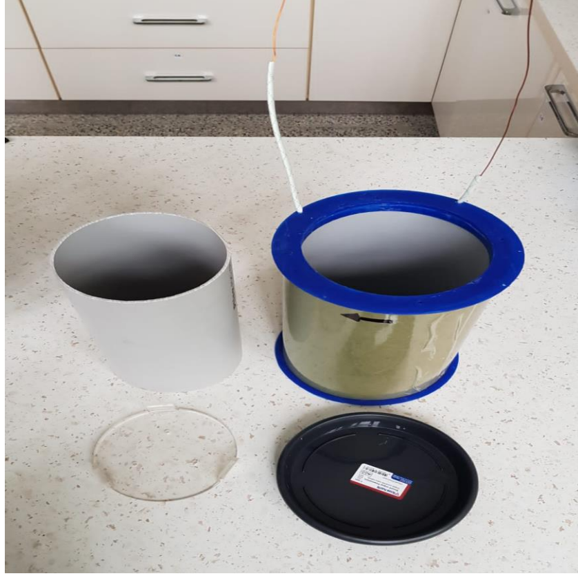
Şekil 3.10. Bobin saksı parçaları
