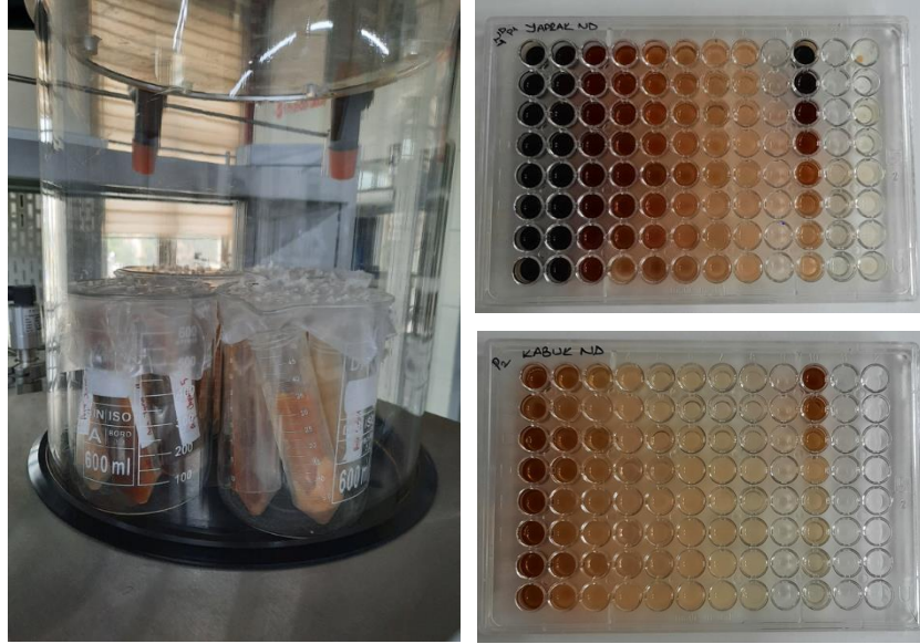
Şekil 3.5. Diyalize olmayan fraksiyonun liyofilizasyonu ve 96 kuyucuklu plakada antimikrobiyal analizleri
