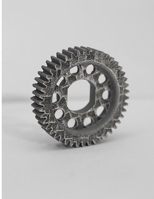
Şekil 2.1. Eİ yöntemi ile üretilmiş bir örnek (Anonim, 2023e)
