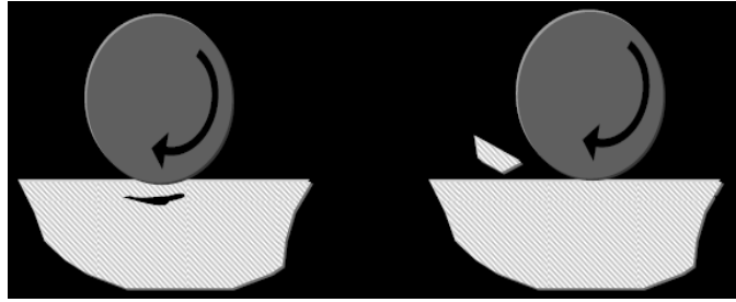
Şekil 2.14. Yorulma aşınması şematik gösterimi (Anonim, 2023h)
