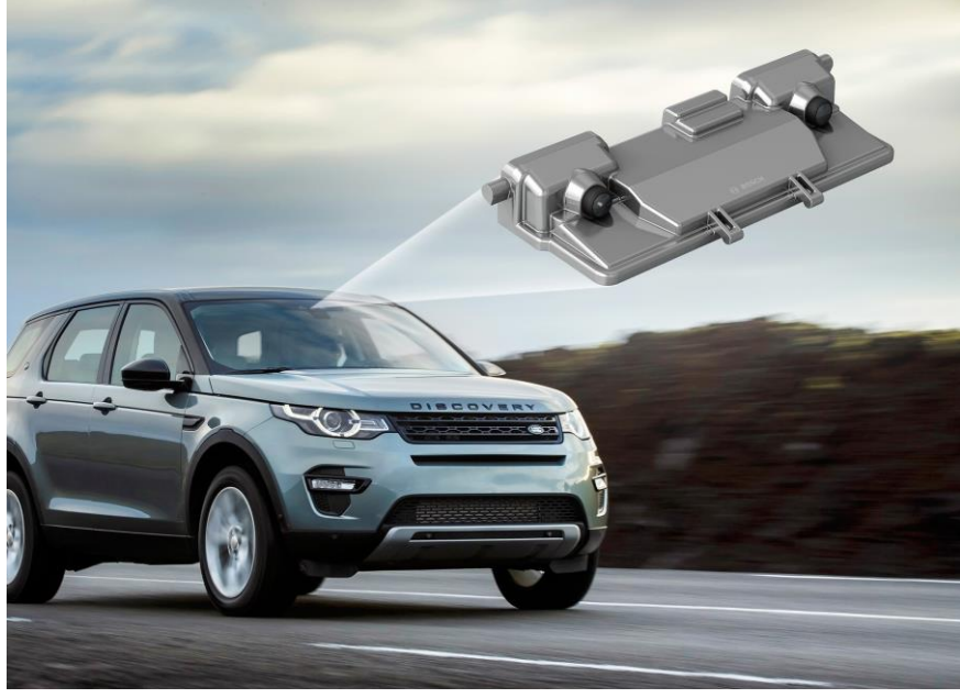
Şekil 3.17. Stereo kameranın araç üzerine entegrasyonu
