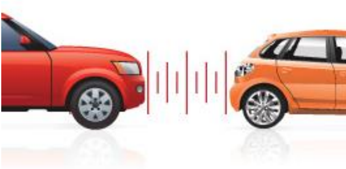
Şekil 3.23. Adaptif hız sabitleyici (ACC) teknolojisi
