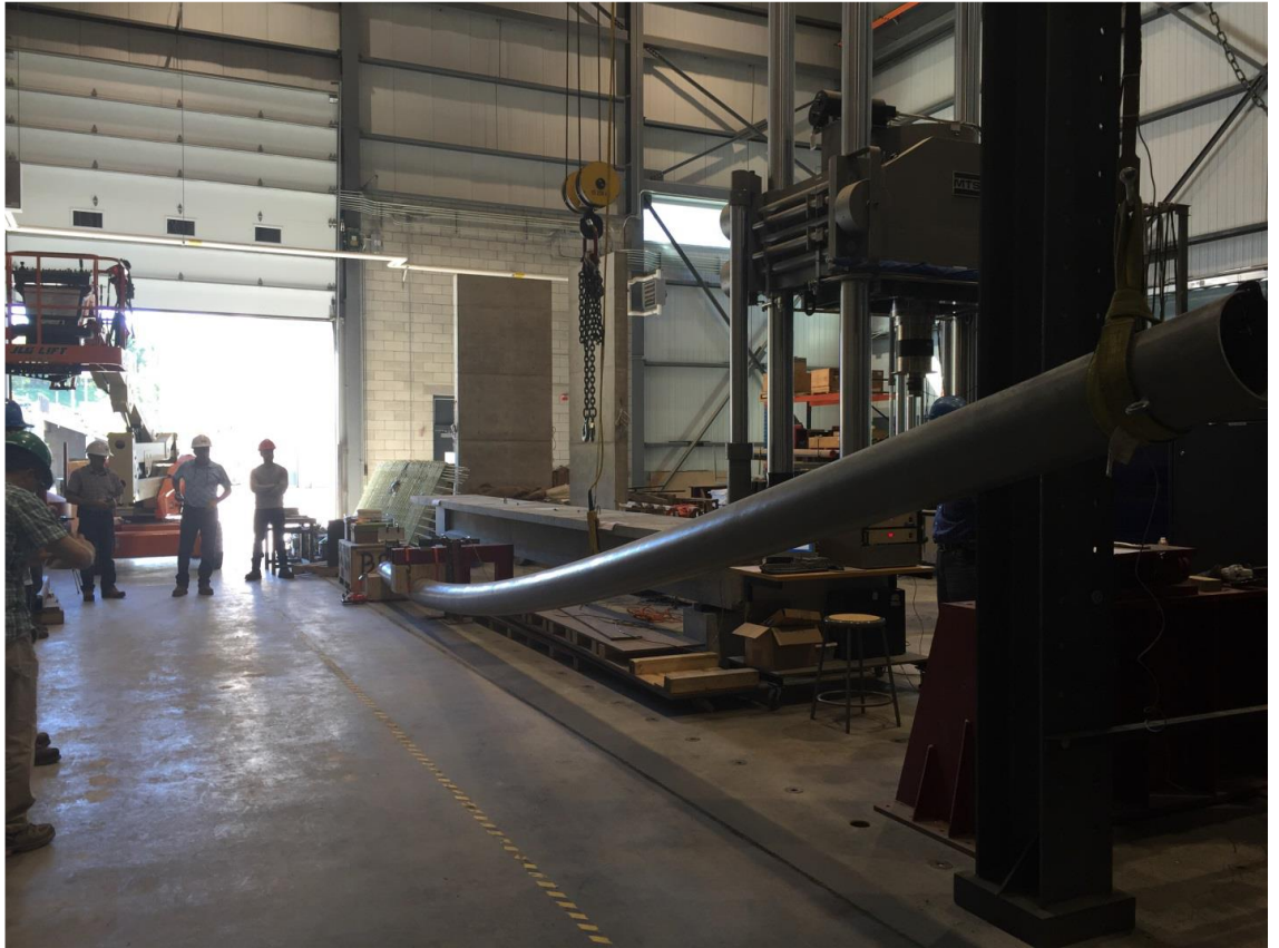
Şekil 4.3: Test edilen direğine yük uygulama aşaması
