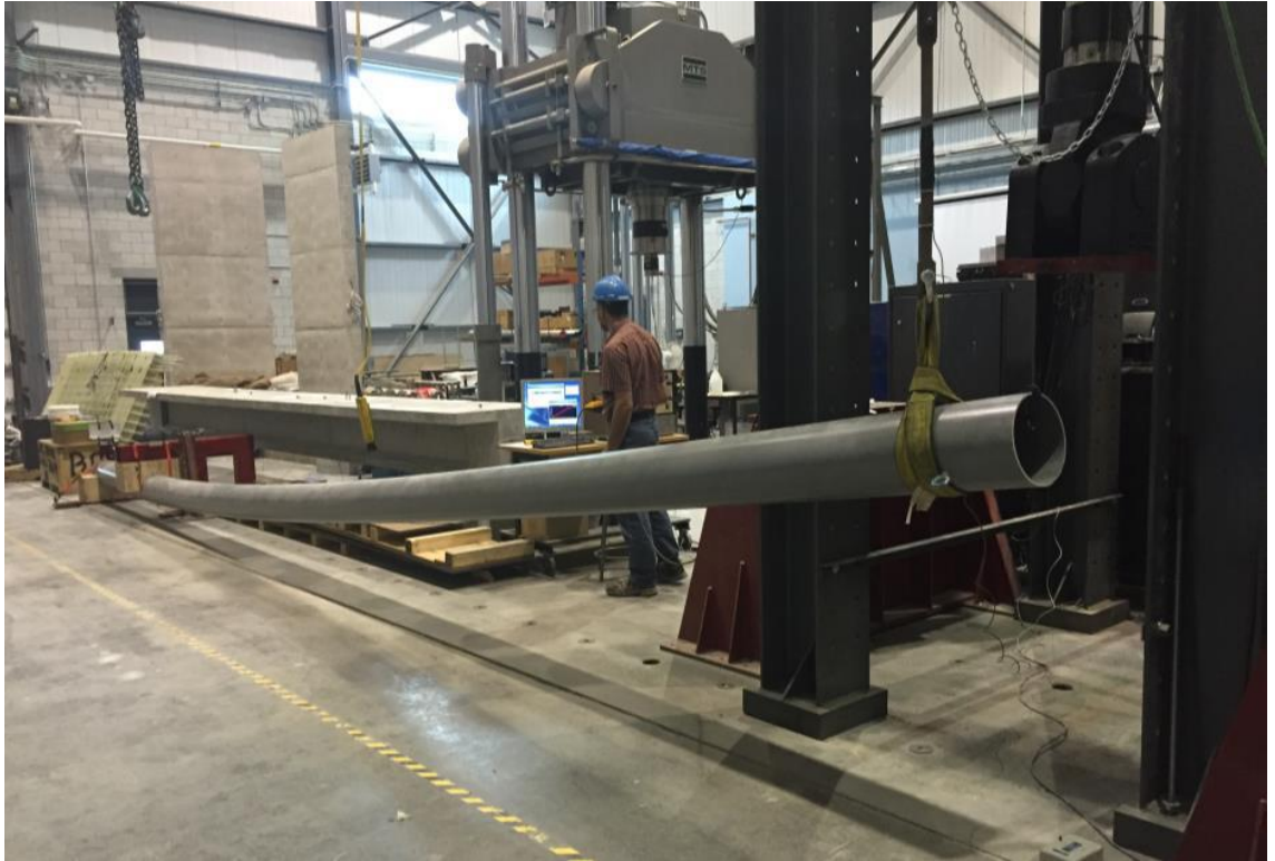
Şekil 3.12. Direğin teste hazırlanma şekli (Mohamed ve ark., 2019)
