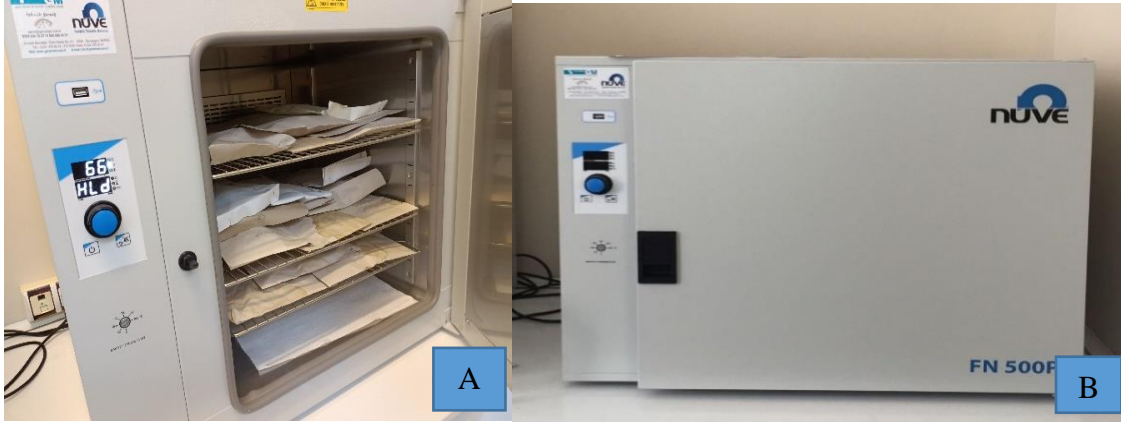
Şekil 3.10. Meyvelerin etüvde kurutulması. A. Etüvün iç görünümü. B.Etüvün dış görünümü.
