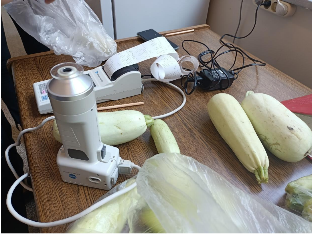
Şekil 3.9. Kabaklarda renkölçer ile meyve rengi ölçümü
