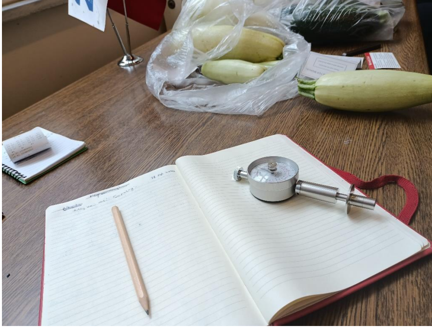
Şekil 3.8. Penetrometre meyve eti sertliği ölçümü
