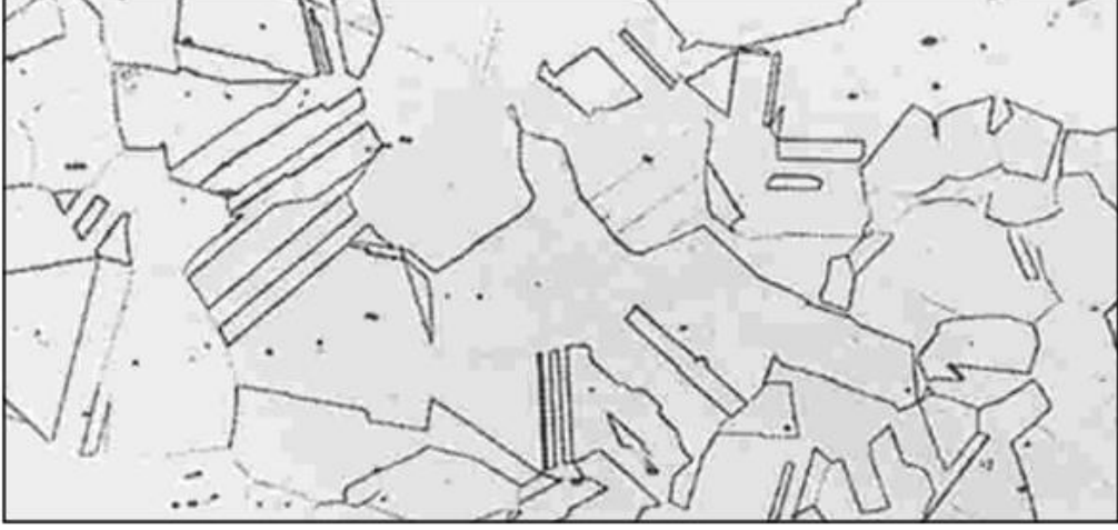
Şekil 2.8. Östenitik paslanmaz çeliklerin mikro yapısı (Saritaş Çelik 2012)
