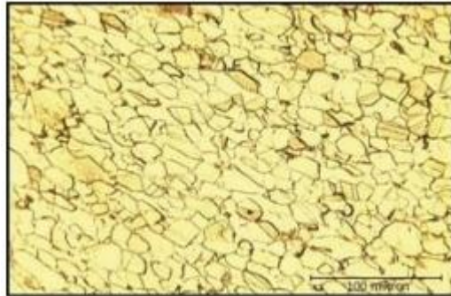
Şekil 2.12. Çift Fazlı (Dubleks) paslanmaz çeliğinin mikro yapısı (Gardi 2017)
