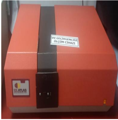
Şekil 3.26. SDL Atlas UV geçirgenliği ölçüm cihazı
