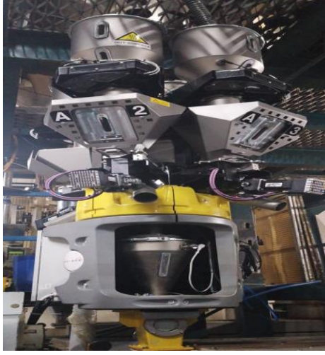
Şekil 3.6. Dotec masterbatch dozajlama ünitesi
