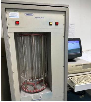
Şekil 3.20. Texturmat ME iplik kıvrım değeri ölçüm cihazı
