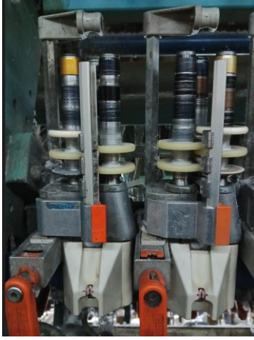
Şekil 3.16. DTY iplik üretiminde S-Z Agregat ünitesi
