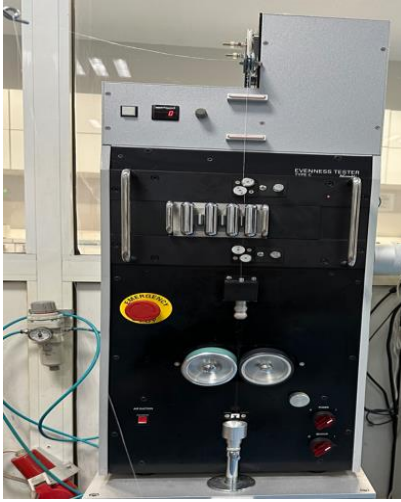
Şekil 3.13. Evenness Type C düzgünsüzlük ölçüm cihazı
