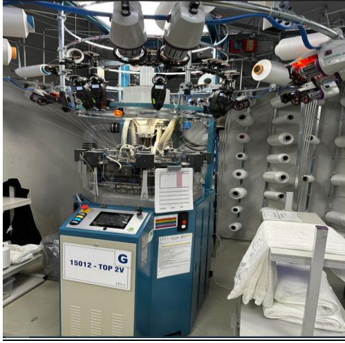
Şekil 3.23. Santoni marka seamless örme makinesi
