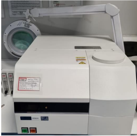
Şekil 3.5. Hitachi 7020 DSC cihazı
