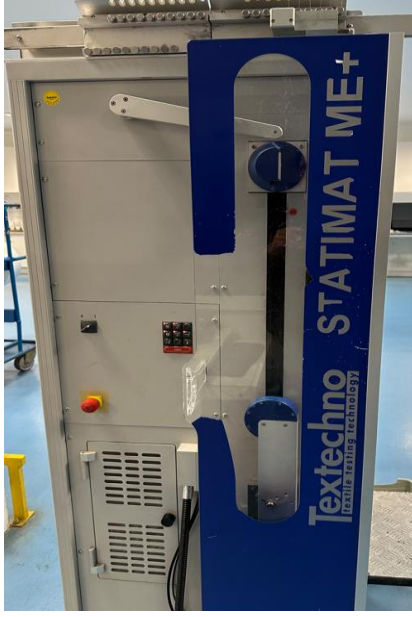
Şekil 3.14. Statimat ME+ kopma uzama ve mukavemet ölçüm cihazı
