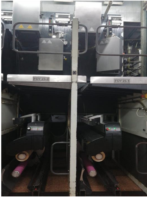
Şekil 3.7. Barmag poy üretim makinesi
