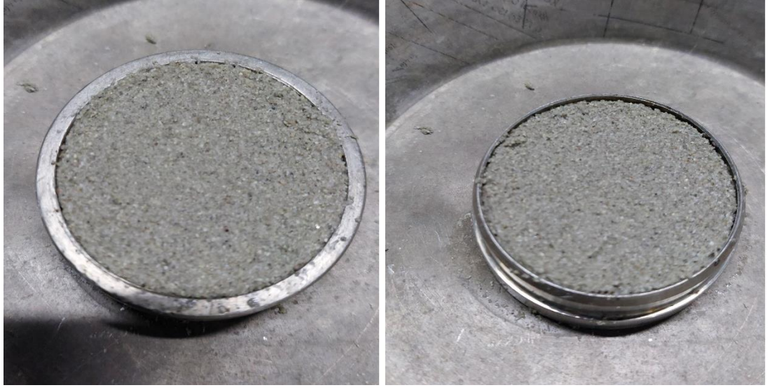
Şekil 3.10. Direkt kesme deneyi için %80 sıklıkta hazırlanmış bir numune örneği
