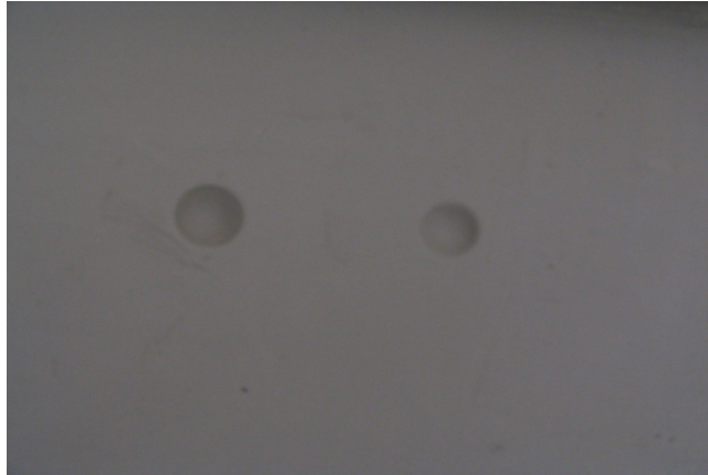
Şekil-35: Bilyenin şahit numune üzerinde oluşturduğu çukur
