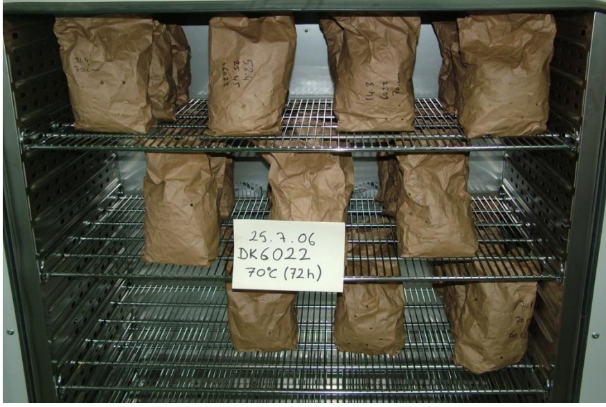
Şekil 3.12. Kuru Maddenin Yüzdesinin Belirlenmesi İçin Kurutma İşlemi
