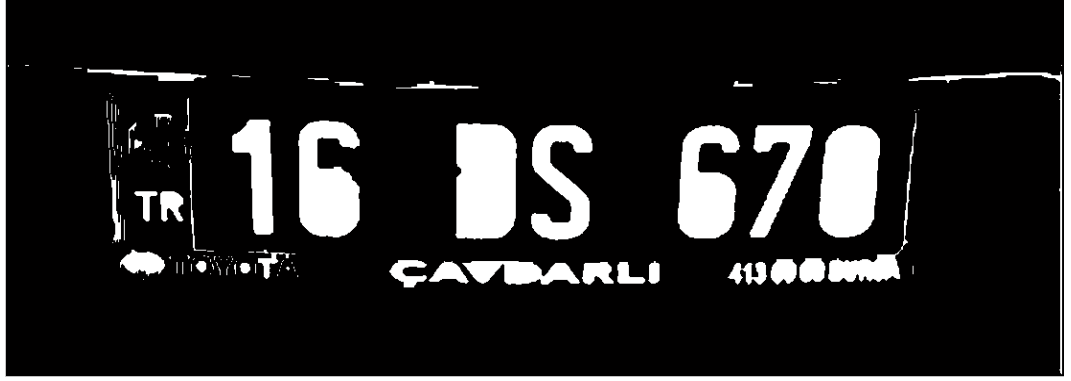
Şekil 3.53. Morfolojik ve aşındırma işlemleri yapılan görüntü
