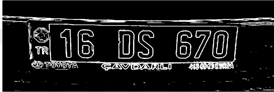
Şekil 3.20. Görüntüye konvolüsyon işlemi uygulanmıştır
