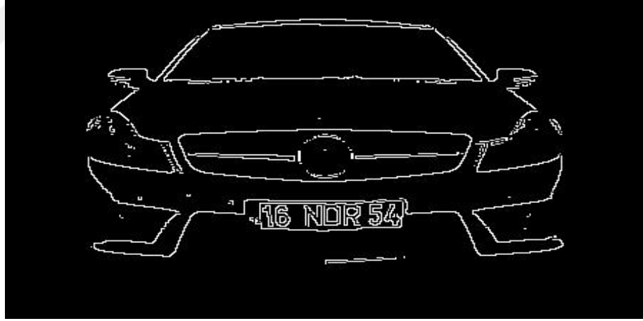
Şekil 3.42. Kenar işleme işlemi uygulanmış resim
