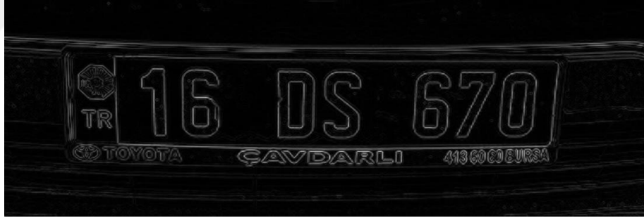
Şekil 3.19. Görüntüye Edge detection uygulanması
