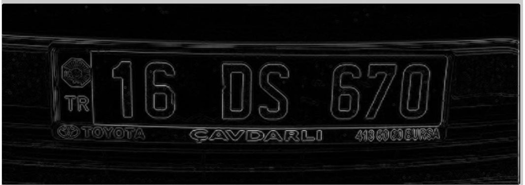
Şekil 3.49. Kenar iyileştirilmesi yapılmış görüntü
