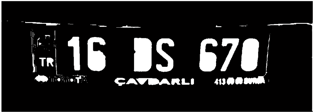
Şekil 3.55. Plakanın kenar bölgesinde bulunan gürültünün temizlenmesi
