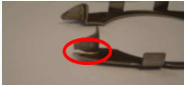
Şekil 3.2 H4 Histerezis Rondelasındaki Yırtılma
