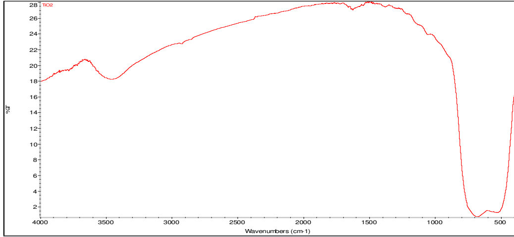
Şekil 3.6.2.1. Titanyum dioksit FTIR Spektrumu
