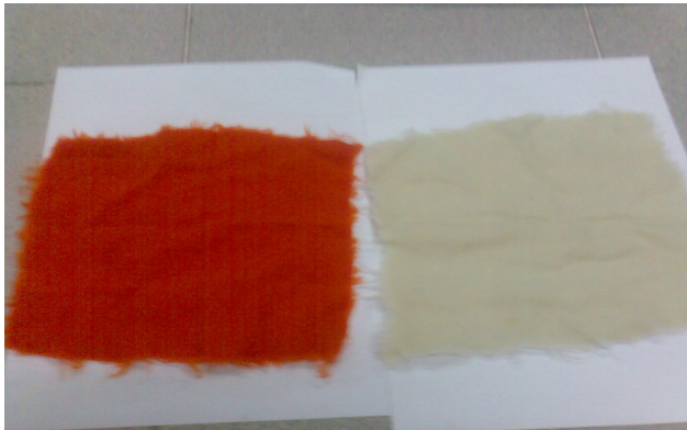
Şekil 2.3.2.2. Acid Orange 7 ile yapılan boyama sonrası kumaş resmi
