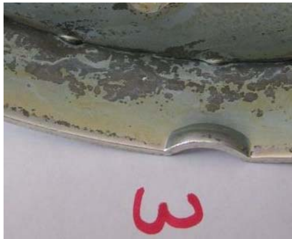
Şekil 3.3 1A akımda 750 saniye kaplanan parçaların tuz sisi test sonuçları
