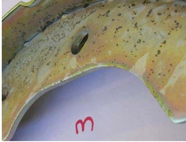
Şekil 3.2 2A akımda 500 saniye kaplanan parçaların tuz sisi test sonuçları
