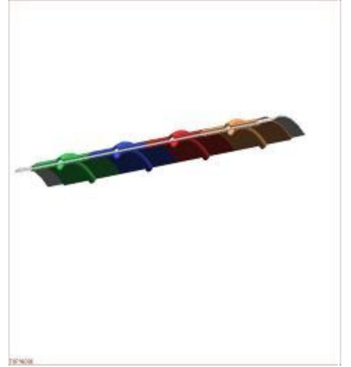
Şekil 42. 2. ve/veya 3. Geçişlere Konulan Yay Tipi Geciktirici Model
