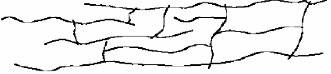
Şekil 1.2 Termoset moleküllerin çapraz bağlanması
