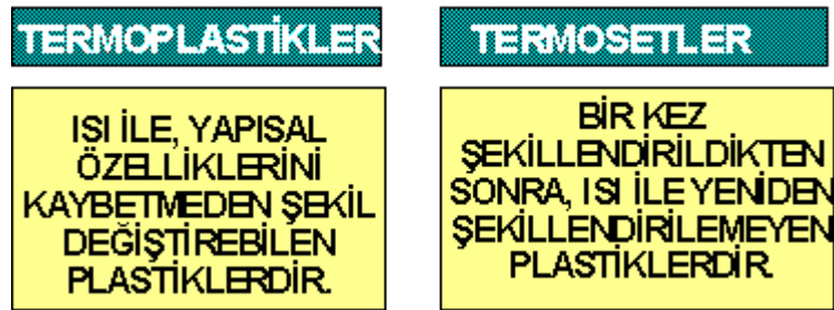
Şekil 1.1 Tekstil kompozitlerinde kullanılan reçinelerin sınıflandırılması
