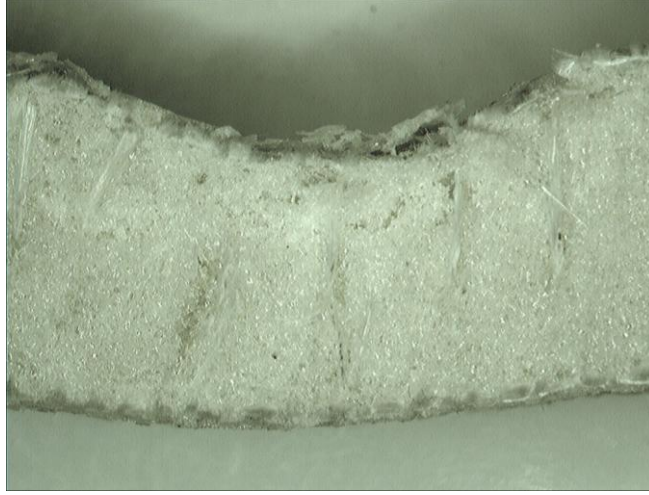
Şekil 3.7 Köpük ilave edilen kompozit numunelerinde üç noktalı eğilme testi sonucu meydana gelen deformasyon
