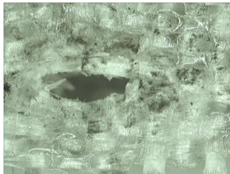
řekil 3.10 Charpy testi sonucu meydana gelen deformasyon
