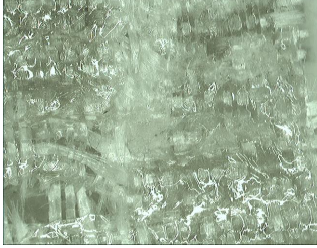
Şekil 3.3 Çekme testi sonucu meydana gelen deformasyon
