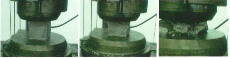
Şekil 3.2. Deney numunesinin basma sırasındaki deformasyonu
