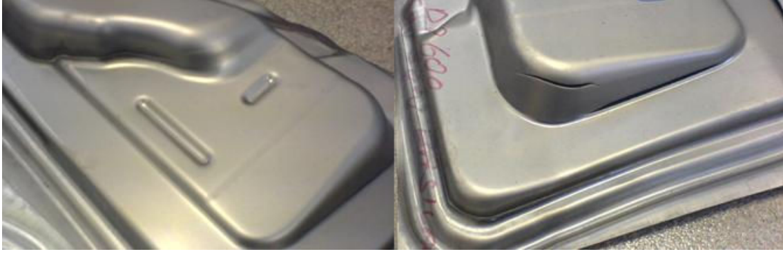
Şekil 7.5 DP600 Çekme Operasyonunda Yırtılma Yapan Bölgeler
