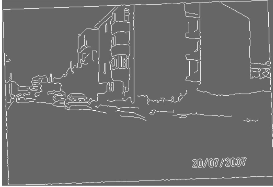
Şekil 2.42 Şekil 2.41'deki RGB görüntünün kenar haritası
