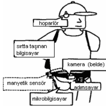
Şekil 1.34 GÖ için önerilen taşınabilir bir navigasyon sistemi (Kaluvahandi ve Tadokoro 2001)
