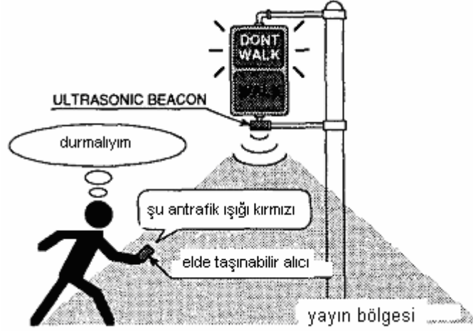
Şekil 1.7 Ultrasonik signpost sistem (Koshi ve ark. 1992)
