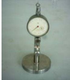
Ek - 4. Yumurta Kabuk Kalınlığı Ölçümü
