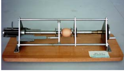
Ek - 2. Yumurta Kırılma Direnci Ölçümü
