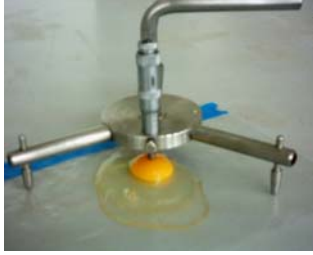
Ek - 3. Yumurta Sarı Yüksekliği Ölçümü
