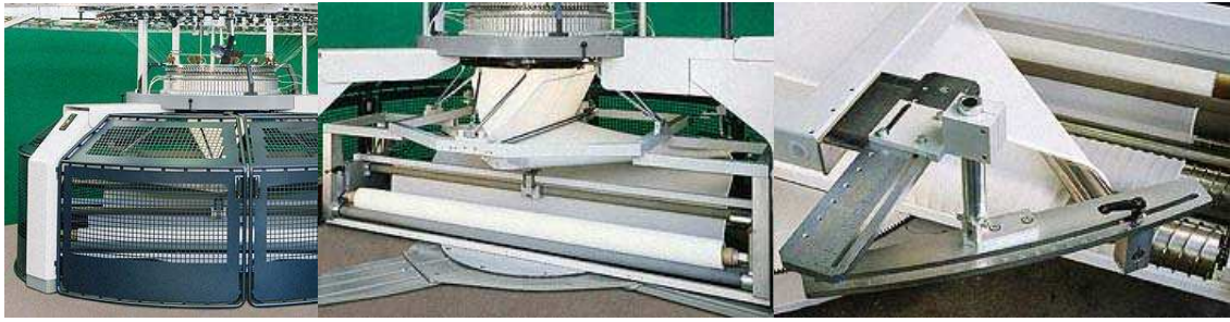
Şekil 2.14 Açık en örme makinelerinde kumaş çekme ve sarma sistemi(Mayer&Cie)
