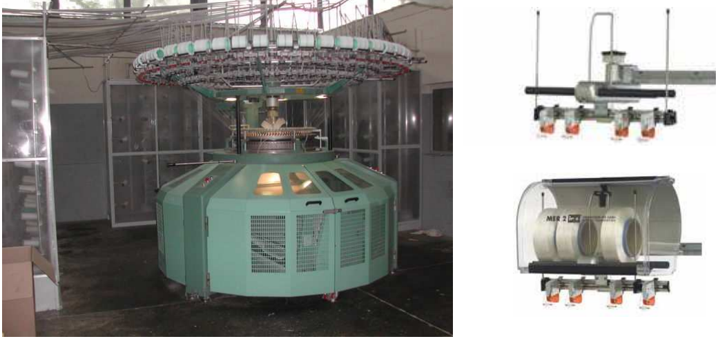
Şekil 3.2. (a) Pilotelli marka JVCE3TA1 model açık en süprem makinesi, (b) Pozitif Beslemeli Memminger Iro MER2 iplik sevk sistemi
