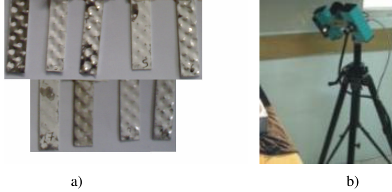
Şekil 3.7 a) Tersine Mühendislik Çalışmalarında Kullanılan Numuneler b) Tersine Mühendislik Çalışmalarında Kullanılan Optik Tarama Cihazı
