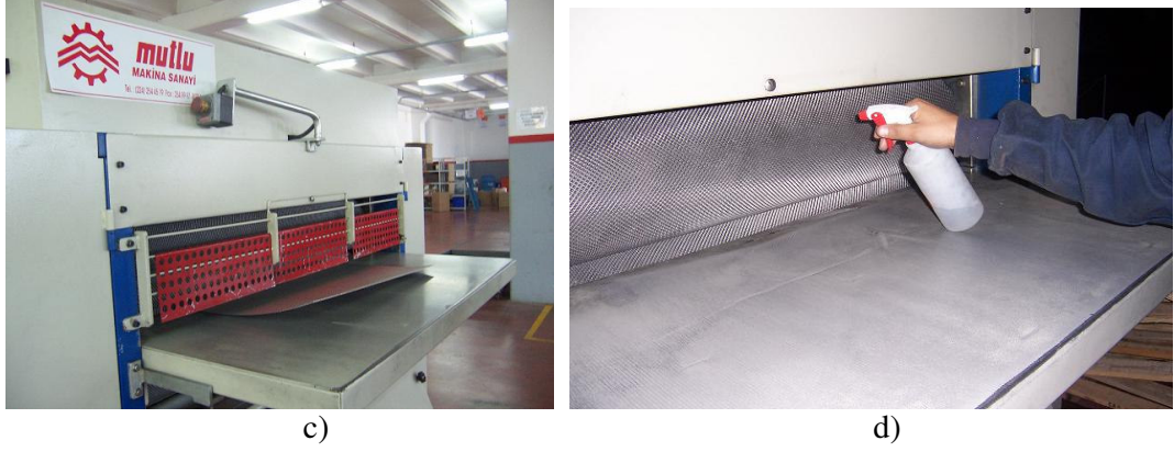
Şekil 3.1 a) Ompaş Firması Bünyesinde Bulunan Desenleme Makinası b) Desenleme Makinasına Sac Girişi c) Desenleme Makinasından Sac Çıkışı d) Desenleme İşleminin Gerçekleşmesi
