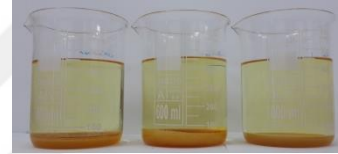
400 ml kanola yağı 200 ml metanol 1,5 g NaOH denemeleri
