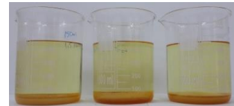
400 ml kanola yağı 150 ml metanol 1,5 g NaOH denemeleri
