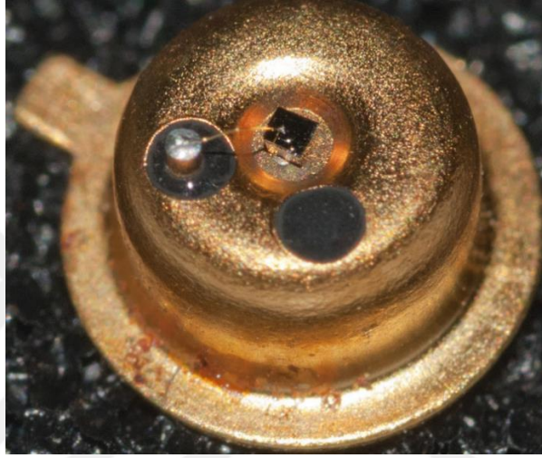
Şekil 3.6. Standart diyot kalıbına yerleştirilmiş olan numune
