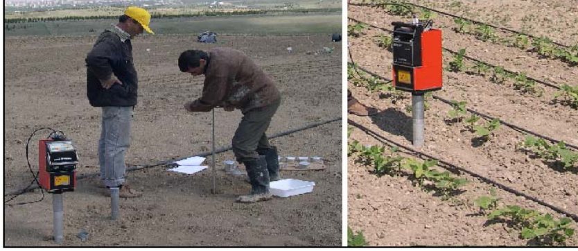
Şekil 2. Nötron prop kalibrasyonu ve yeşil fasulye parselinde toprak su içeriği ölçümü
