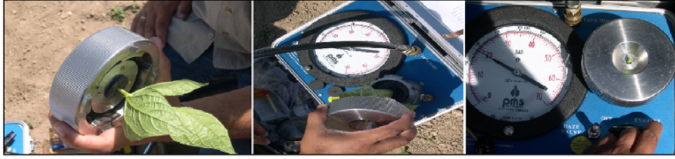
Şekil 4. Basınç odası ile yeşil fasulye yaprak su potansiyeli ölçümü
