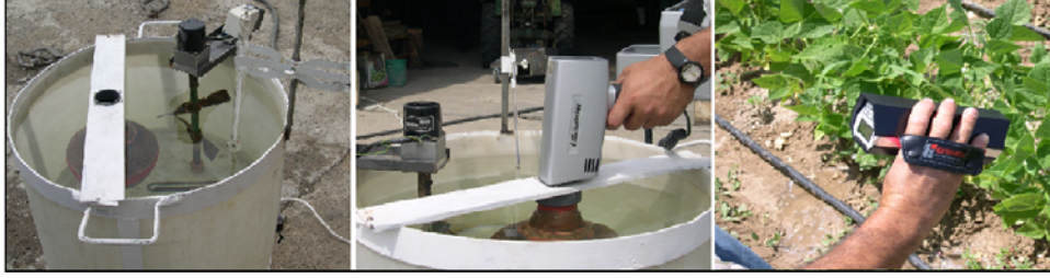
Şekil 3. İnfrared termometre kalibrasyonu ve yeşil fasulye bitki örtüsü yüzey sıcaklığı ölçümü
