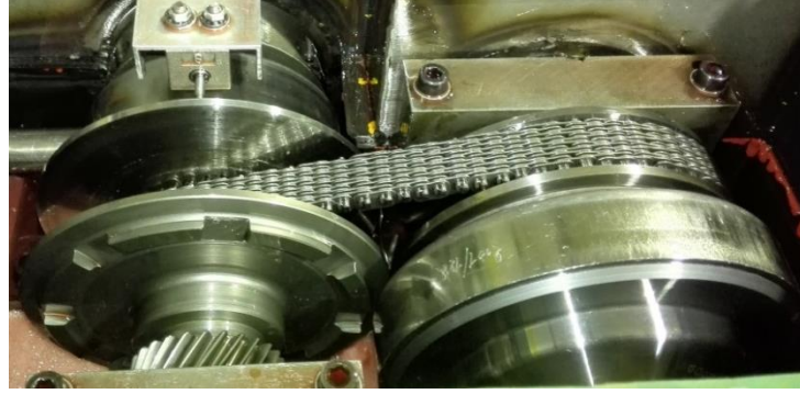
Şekil 3.28. Deney düzeneğinde kullanılan zincirli SDA Sistemi
