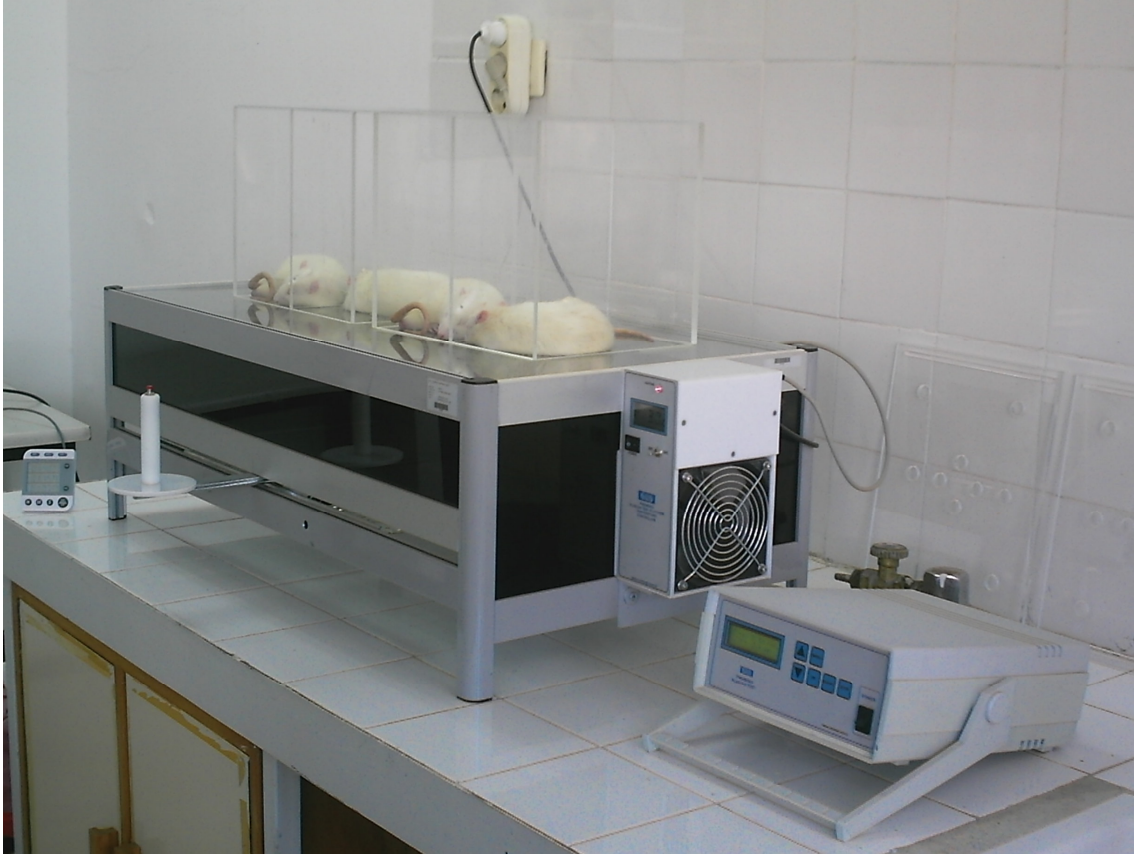
Şekil – 8: Termal Pençe Çekme Testi
