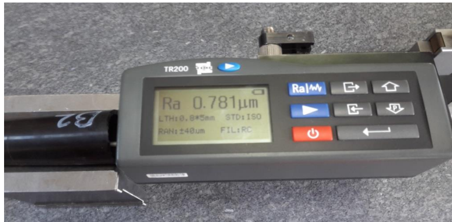
Şekil 3.10. Memelik lastiği pürüzlülük deneyinin yüzey pürüzlülük cihazı ile yapılışı
