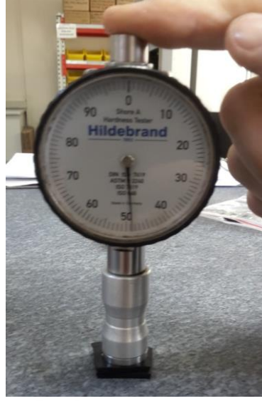
Şekil 3.9. Sertlik ölçme cihazının kauçuk parça üzerine uygulanışı
