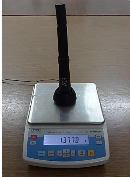
Şekil 3.12. Memelik lastiğinin dijital terazide ölçümü
