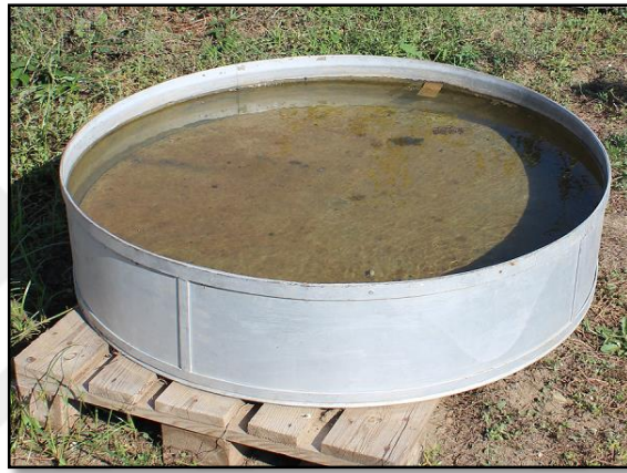
Şekil 3.5. Denemede kullanılan A sınıfı buharlaşma kabı.
