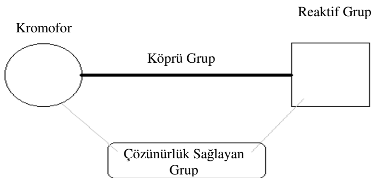
Şekil 2.13. Bir Reaktif Boyarmadde Molekülünün Genel Yapısı
