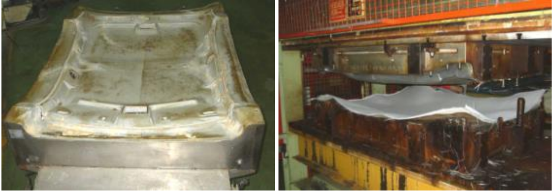
Şekil 3.18. Alüminyum form kalıbı açık halde
