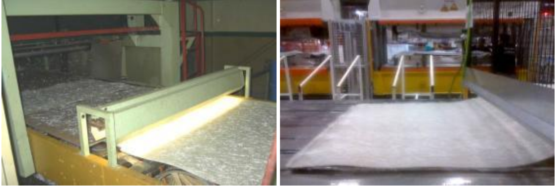
Şekil 3.17. Sandviç malzeme tabakalarının pres baskıya hazırlanması
