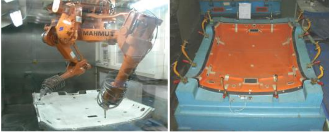
Şekil 3.19. Su jeti ile parça kesimi ve kontrol aparatı
