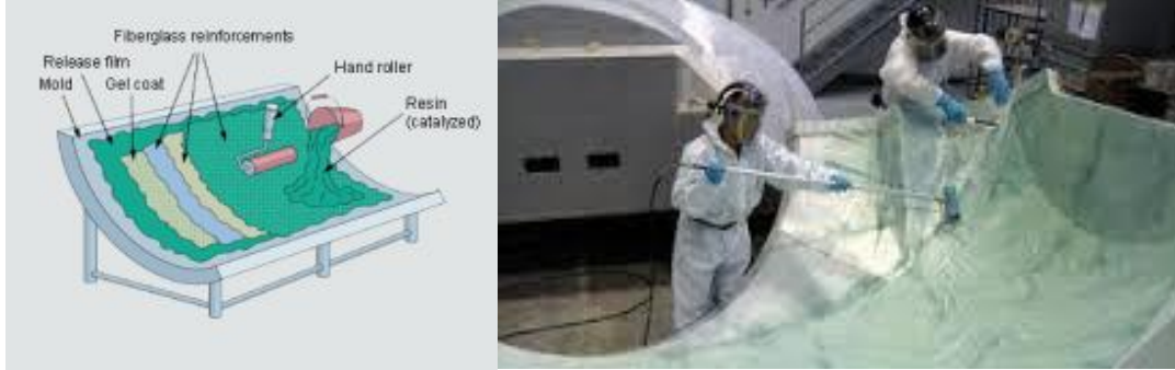
Şekil 3.5. Elle yatırma yöntemi ( www.reinforcedplastics.com )
