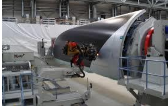
Şekil 3.7. Otomatik yayarak kalıplama yöntemi ( www.reinforcedplastics.com )
