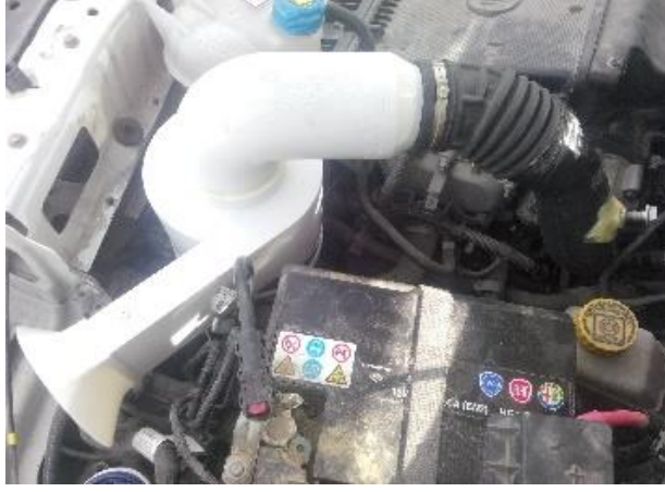
Şekil 3.11. Hızlı prototip siklon ayırıcının motor boşluğuna uyarlanması
