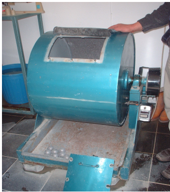
Şekil 3.2. Agrega aşınma dayanım aleti (Sinta Beton Laboratuvarları Z.Şimşek arşivi 2005)
