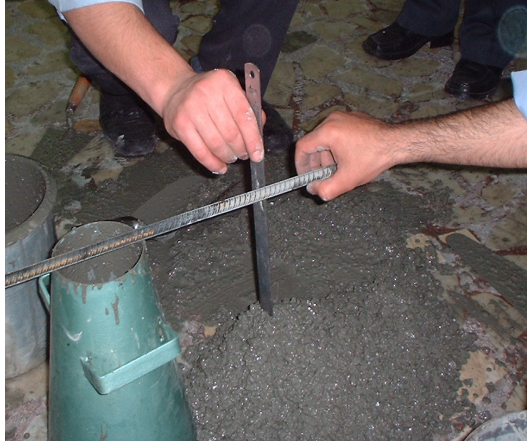
Şekil 4.5. Slump deneyi (Z.Şimşek arşivi 2005)
