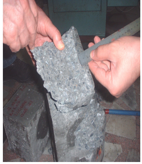
Şekil 4.13. Numuneye nüfuz eden su miktarının ölçülmesi (Z.Şimşek arşivi 2005)
