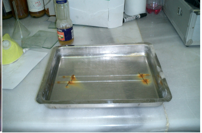
Şekil 4.15. Kılcallık deneyi düzeneğinin kurulması (Z.Şimşek arşivi 2005)
