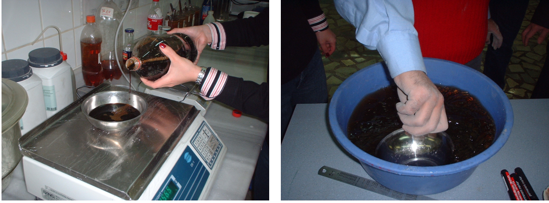
Şekil 2.47. Akışkanlaştırıcı katkı maddesinin tartımı ve karışım suyuna ilave edilmesi (Z.Şimşek arşivi 2004).
