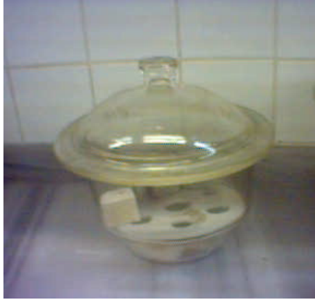
Şekil 4.14. Numunenin etüvde neminin alınması (Z.Şimşek arşivi 2005)
