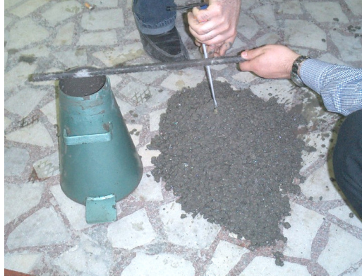
Şekil 3.3. Akıcı kıvamlı beton (Z.Şimşek arşivi 2005)
