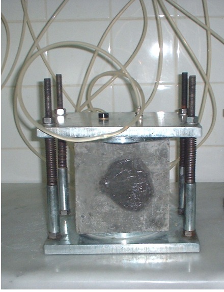
Şekil 4.12. Basınçlı su geçirimsizlik deney aleti (Z.Şimşek arşivi 2005)
