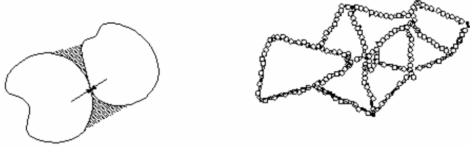
Şekil 2.18. Kapiler çekme gerilmelerinin zemin taneciklerine olan etkisi (Z. Şimşek).
