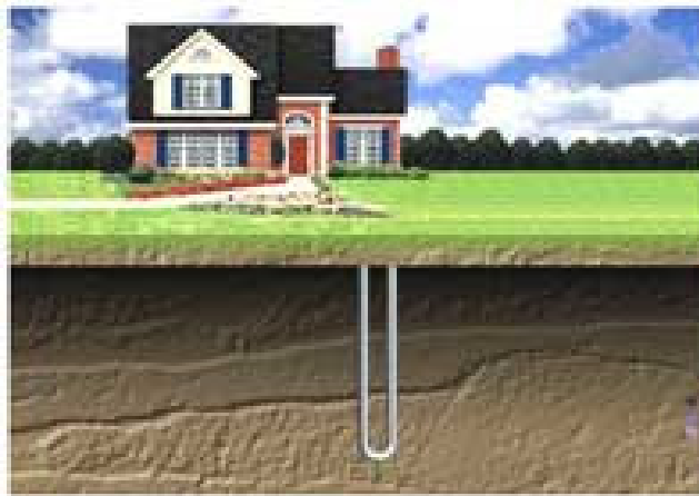
Şekil 2.17. Dikey tip toprak ısı değiştiricisi uygulama şeması
