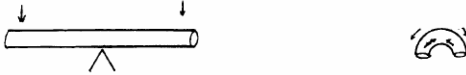
a) İnce çubukta eğilme kuvveti
