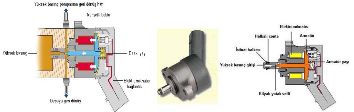
Şekil 3.12 Yakıt Basıncı Ayar Valfi
