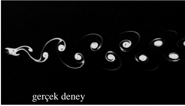
Şekil 3.39 CFD simülasyonu ve gerçek akış ile bir kütle üzerine gelen akışın kütle arkasında izlenimi (kaynak: http://www.mathematik.uni-dortmund.de/kuzmin/cfdintro/cfd.html , 2009)
