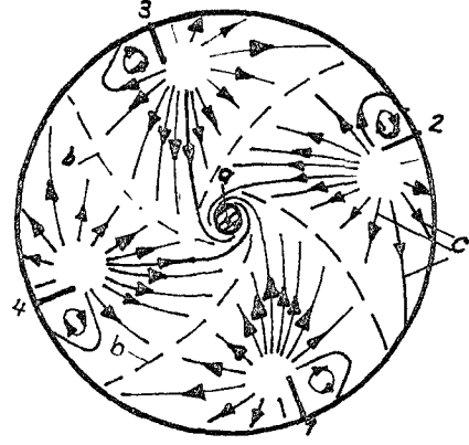
Şekil 4.21 Akışkan dış yüzeyindeki akımlar
