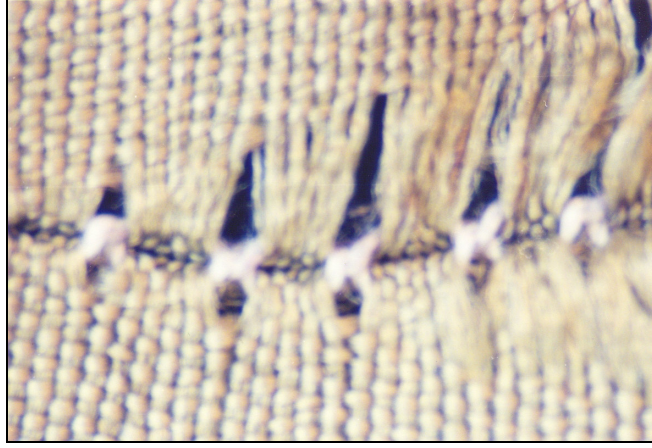
Şekil 5.107. 2. grup 4 nolu DPA1PE kodlu numunede dikiş açması ve sırtmasının optik mikroskopta görüntüsü (x 10)
