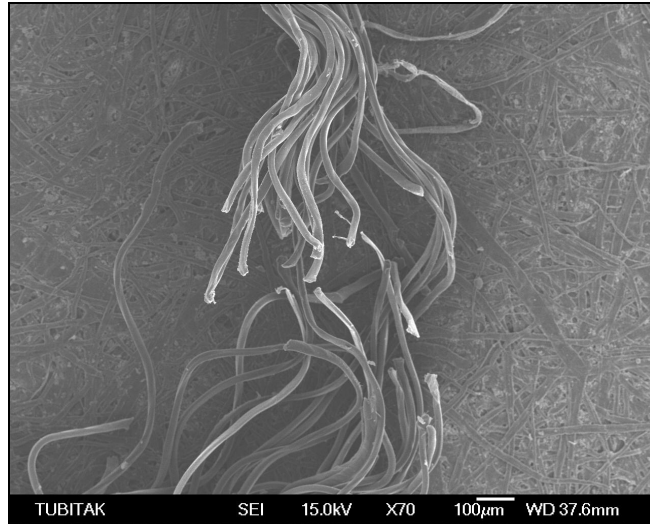
Şekil 5.97. 1. grup 11 nolu C2S2T2 kodlu numunede hasarlı atkı ipliğinin SEM görüntüsü
