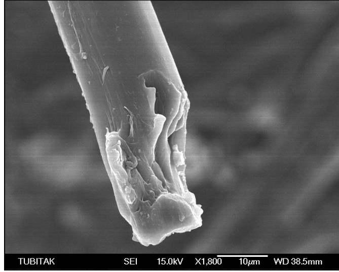
Şekil 5.133. 3. grup 4 nolu BB4NE kodlu numunede hasarlı atkı ipliğinde kopan nylon filamentin SEM görüntüsü
