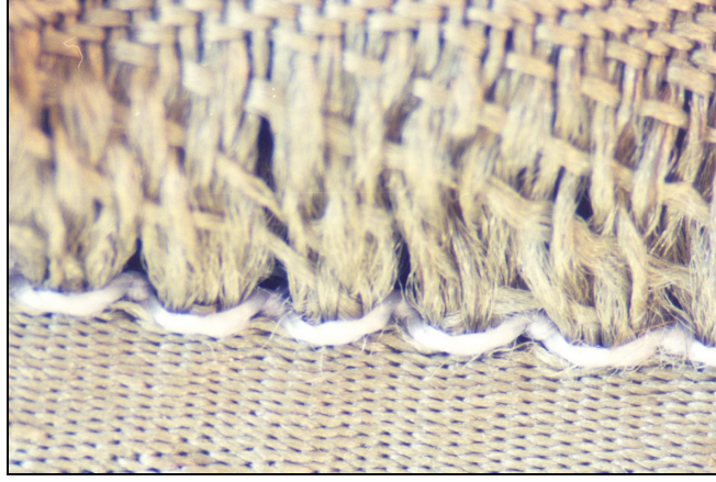
Şekil 5.110. 2. grup 5 nolu DPA2PE kodlu numunede 300 devir tekrarlı yük sonucu dikiş açmasının, optik mikroskofta görüntüsü (x 10)
