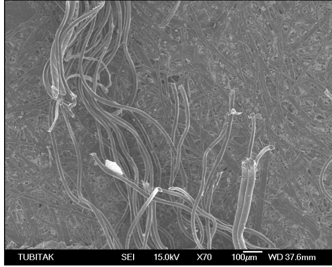
Şekil 5.94. 1. grup 6 nolu C3S2T1 kodlu numunede atkı ipliğininde, kopan elastanın ve onu çevreleyen nylon filamentlerin SEM görüntüsü
