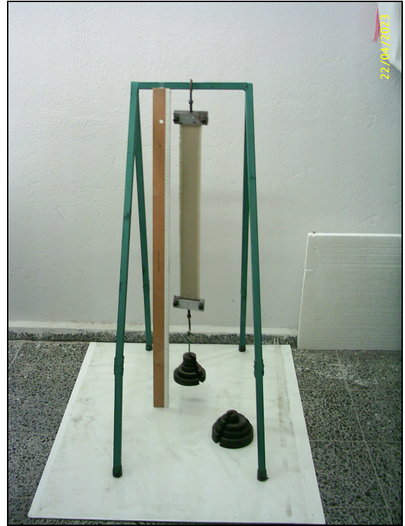
Şekil 3.5. Elastikiyet (Growth) deneyi için kullanılan uzatma cihazı
