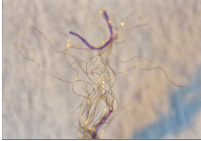
Şekil 5.89. 1. grup 5 nolu C2S2T1 kodlu numunedeki atkı ipliğindeki hasar ve elastanın kopmasının, optik mikroskoptaki görüntüsü (x 25)
