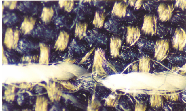
Şekil 5.82. 1. grup 6 nolu C3S2T1 kodlu numunedeki dikiş adımlarının optik mikroskoptaki görüntüsü (x 30)
