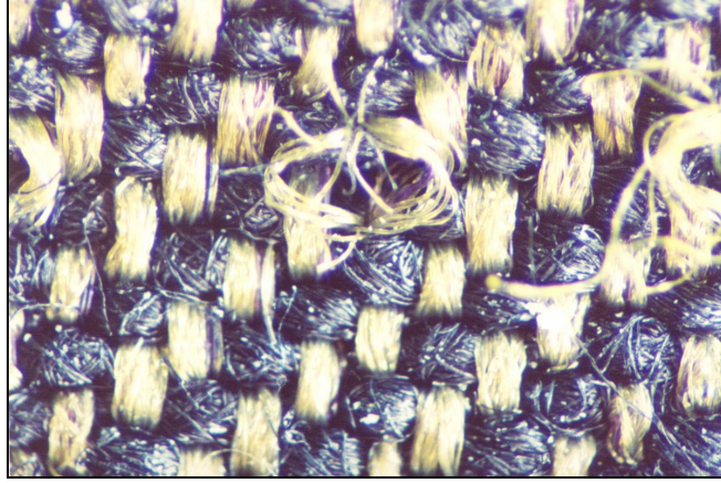
Şekil 5.83. 1. grup 10 nolu C1S2T2 kodlu numunedeki iğne deliğinin optik mikroskoptaki görüntüsü (x 25)
