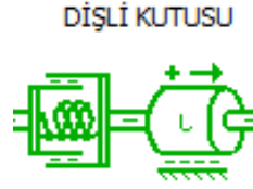
Şekil 4.8. AMESim dişli kutusu modeli
