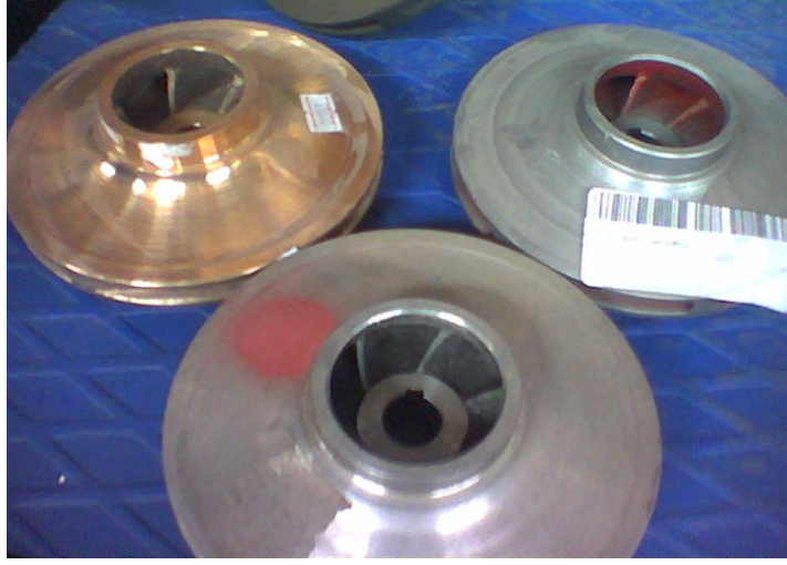
Şekil 5.4. KSB Marka, 3 farklı malzemeden imal, kapalı tip çarklar
