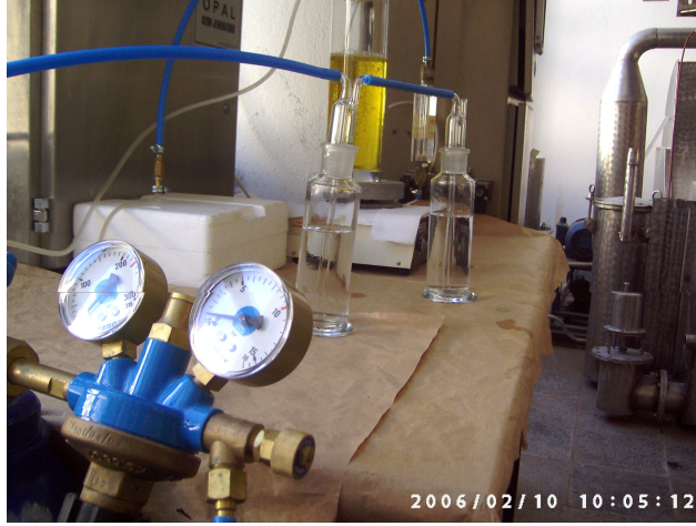
Şekil 3.8 Oksijen Basıncının Ayarlandığı Basınç Ölçüm Cihazı
