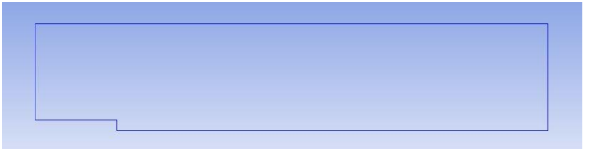
Şekil 3.9. Uyarlanmış Driver ve Seegmiller geometrisi
