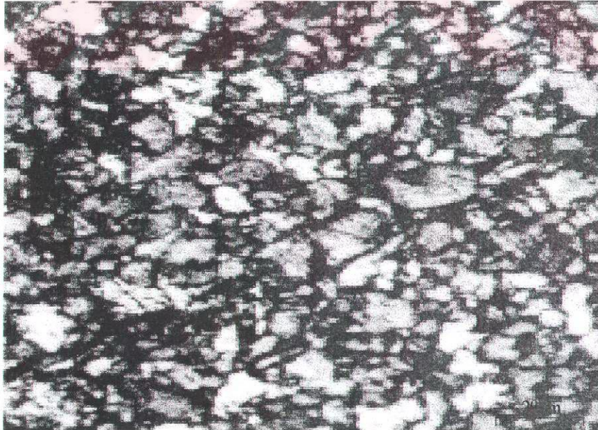
Şekil 4.1. l) 910°C'de 40 dakika tutulup su verilmiş daha sonra 740°C'de 60 dakika süre ile tavlanan su verilen hacimce %26,1 martenzit içeren numunenin mikroyapısı.
