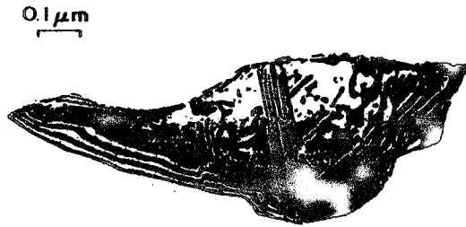
Şekil 2.27. Ferrit matris içindeki kalıntı osteniti gösteren transmisyon elektron mikrografı (Piplani ve Ragravan 1981).
