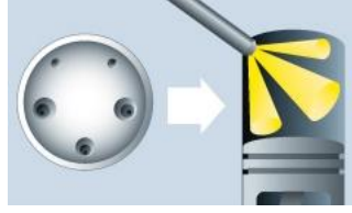
Şekil 2. 19. Yanma odasına, silindir duvarına ve piston yüzeyine temas etmeyen yakıt demeti formu (istenen durum) ( http://www.bosch-presse.de , 2015)
