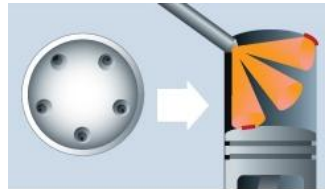
Şekil 2. 18. Yanma odasına, silindir duvarına ve piston yüzeyine temas eden yakıt demeti formu (istenmeyen durum) (http://www.bosch-presse.de, 2015)
