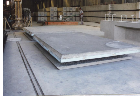
Şekil 2.49. Kalıptan çıkarılan panel
