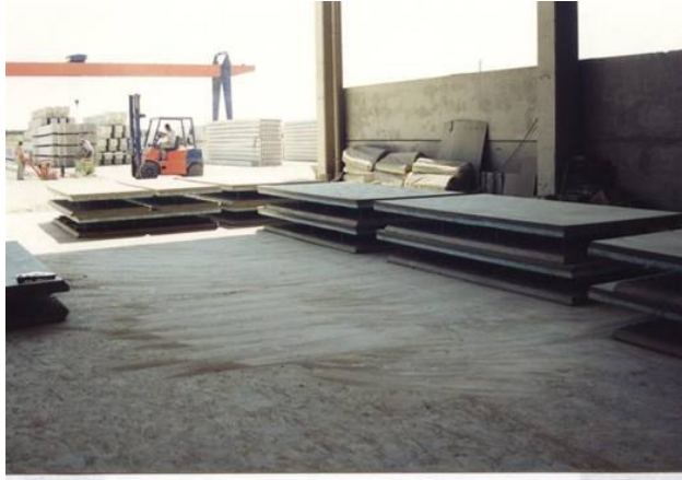
Şekil 2.30. Megablok teknik ile üretilen panellerin istiflenmesi
