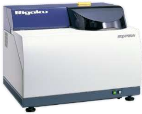
Şekil 3.6. Analizde kullanılan WD-XRF cihazı ve cihazda veri eldesi
