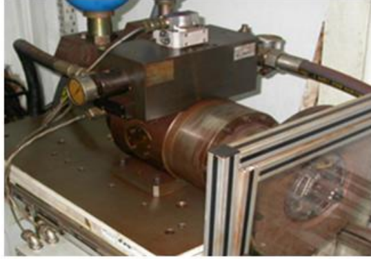
Şekil 3.10. Açısal yorulma test düzeneği
