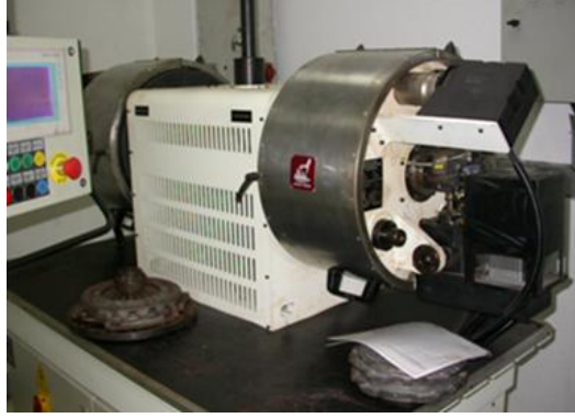
Şekil 3.12. Devir altında eksenel yorulma test düzeneği
