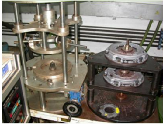
Şekil 3.11. Eksenel yorulma test düzeneği
