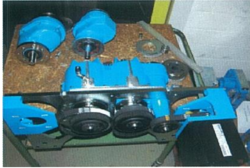
Şekil 2.27. Open-end rotor iplik eğirme makineleri için Amsler firmasının geliştirmiş olduğu ek şantuk donanımı (Anonim 2007)
